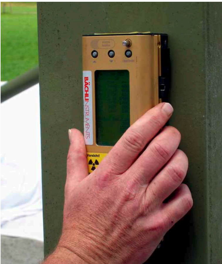
Analyse des métaux lourds avec un spectromètre à fluorescence de rayons X portable
